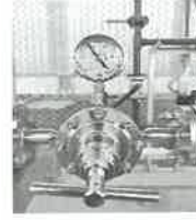
3. ค่าแรงดันการไหลของแอมโมเนียจะต้องไม่เกิน 0.1 Mpa
